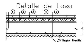
Losas de Hormigon armado H\*17 ADN 42/50
