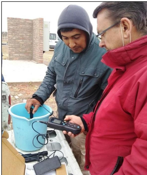
Fig.5. Medición in situ de parámetros químicos del agua de perforación.
