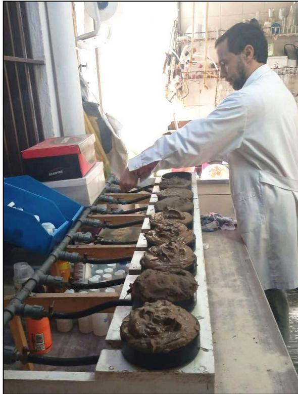
**Fig.8.** Preparación de pastas de suelo en extracto de saturación para medición de CEe
