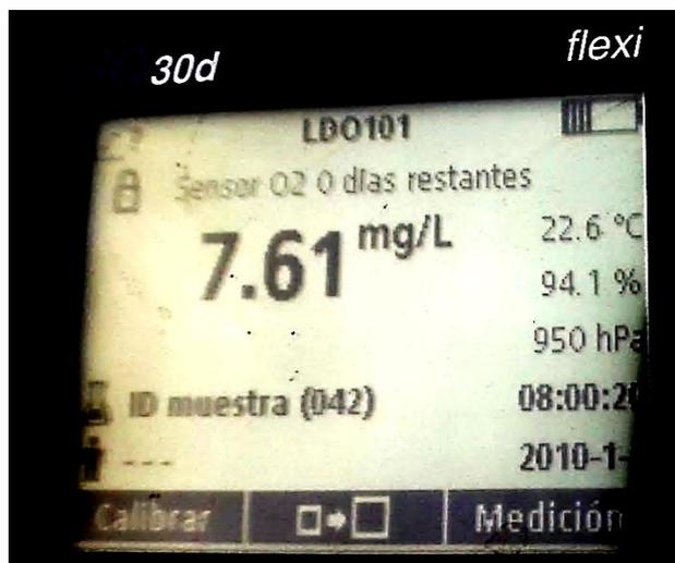
Fig.6. Medición de oxígeno disuelto in situ con electrodo selectivo (oxímetro).
