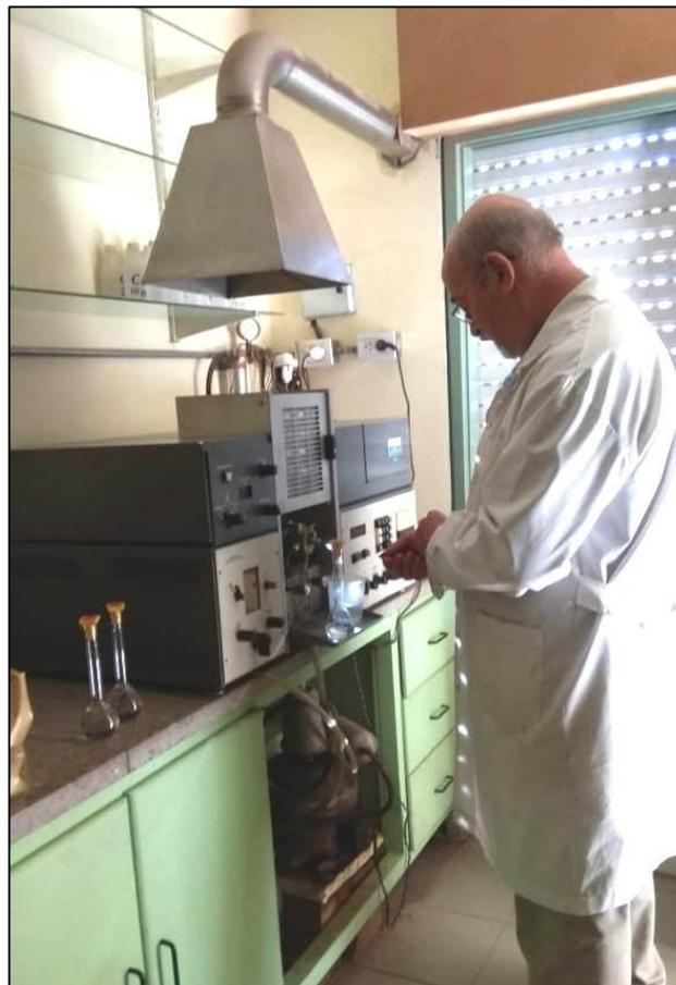
**Fig.9.** Determinaciones químicas por espectrofotometría de absorción atómica.
