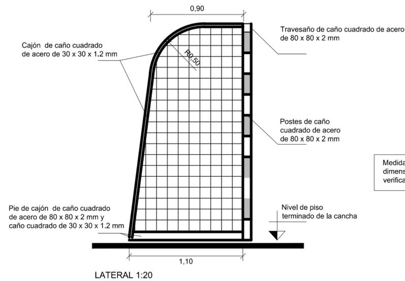
Medidas y secciones de la estructura, y dimensiones de bases estimativas y a verificar según cálculo por la contratista.
