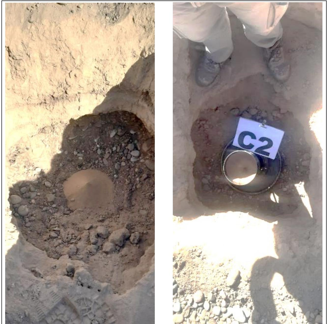
**Fotografía N°10 y 11:** Calicata **C.2.** Se muestra el perfil estratigráfico de suelos formado por un estrato superior de 0,60m de espesor formado por un limo arenoso con gravas, y subyacente aparece el estrato granular grueso del cono aluvial del Río San Juan formado por una grava arenosa. Se muestra el ensayo de densidad in situ por el método del cono y la arena (Norma DNV) a la profundidad de 0,90m en el estrato granular grueso formado por una grava arenosa.
