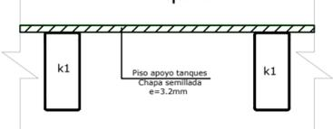
**Detalle Techo Cubierta de Equipos**
