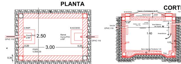
**CÁMARA DE MUESTRAS Y MEDICIÓN DE CAUDALES HASTA 25m³/h.- (0.85 x 0.60)**
