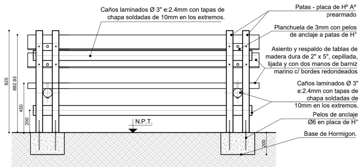
DETALLE FIJACION DE ASIENTO DE MADERA CON PATA DE H°A°
