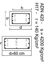
**Detalle armado de Columnas**
