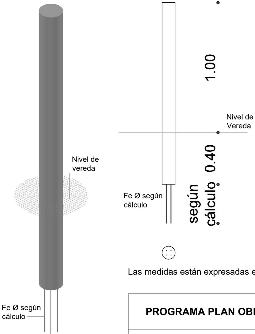
Caño mecánico Ø 100, espesor 5 mm.
