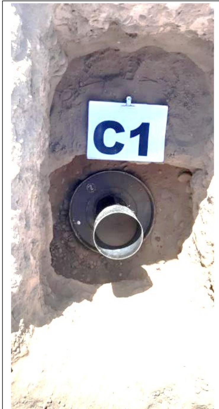
**Fotografía N°7:** Calicata **C.1.** Se muestra el perfil estratigráfico de suelos formado por un estrato superior de 0,70m de espesor formado por un limo arenoso con gravas, y subyacente aparece el estrato granular grueso del cono aluvial del Río San Juan formado por una grava arenosa. Se muestra el ensayo de densidad in situ por el método del cono y la arena (Norma DNV) a la profundidad de 1,00m en el estrato granular grueso formado por una grava arenosa.
