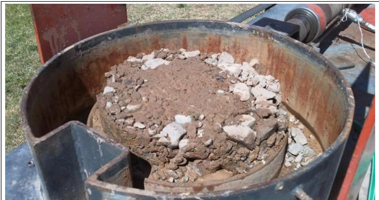
**Fotografía N°13:** Se muestra la probeta ensayada a corte rápido para la calicata C.1 – Prof.= 0,80m; observando el plano de corte.
