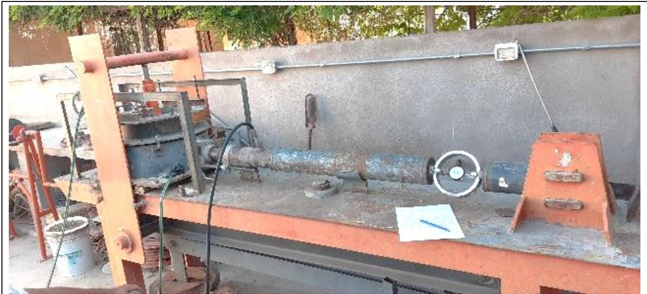
**Fotografía N°12:** Se observa el dispositivo de corte para suelos granulares bajo # 1 1/2" con diámetro 36cm.
