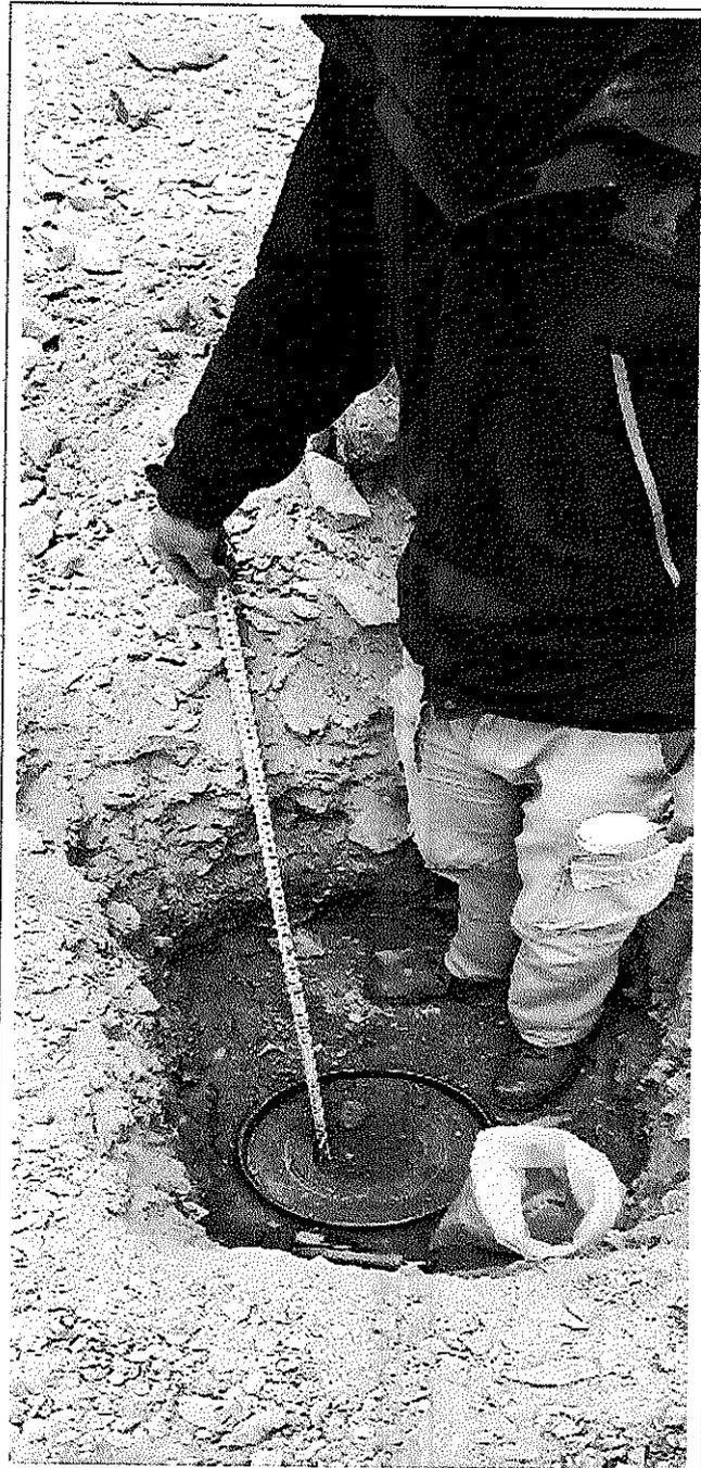
**Fotografía N°13:** Calicata C.3. Se muestra el perfil estratigráfico de suelos formado por una grava limosa angulosa. Se muestra el ensayo de densidad in situ mediante el método del cono y la arena (Norma DNV) a la profundidad de 1,00m.
