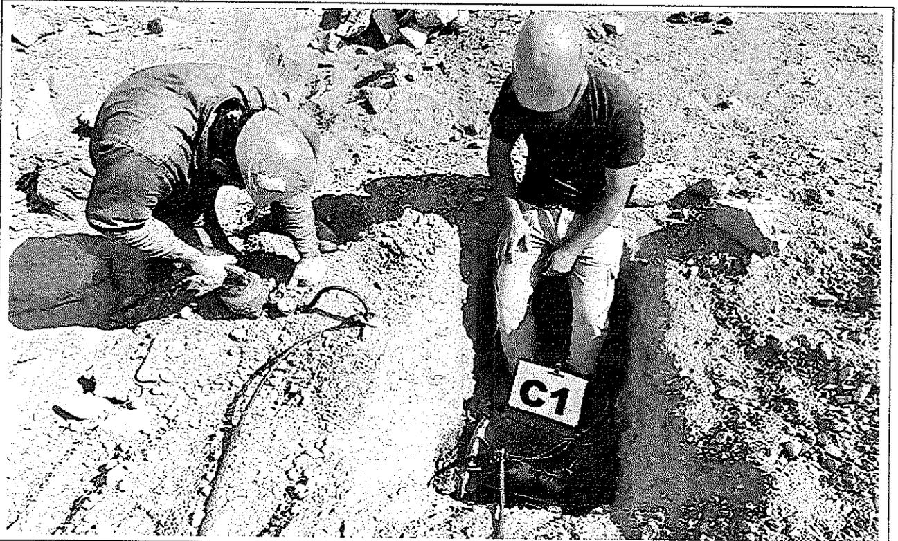
**Fotografía N°5:** Calicata C.1. Se muestra el ensayo de carga horizontal (ECH) a la profundidad de 0,70m.
