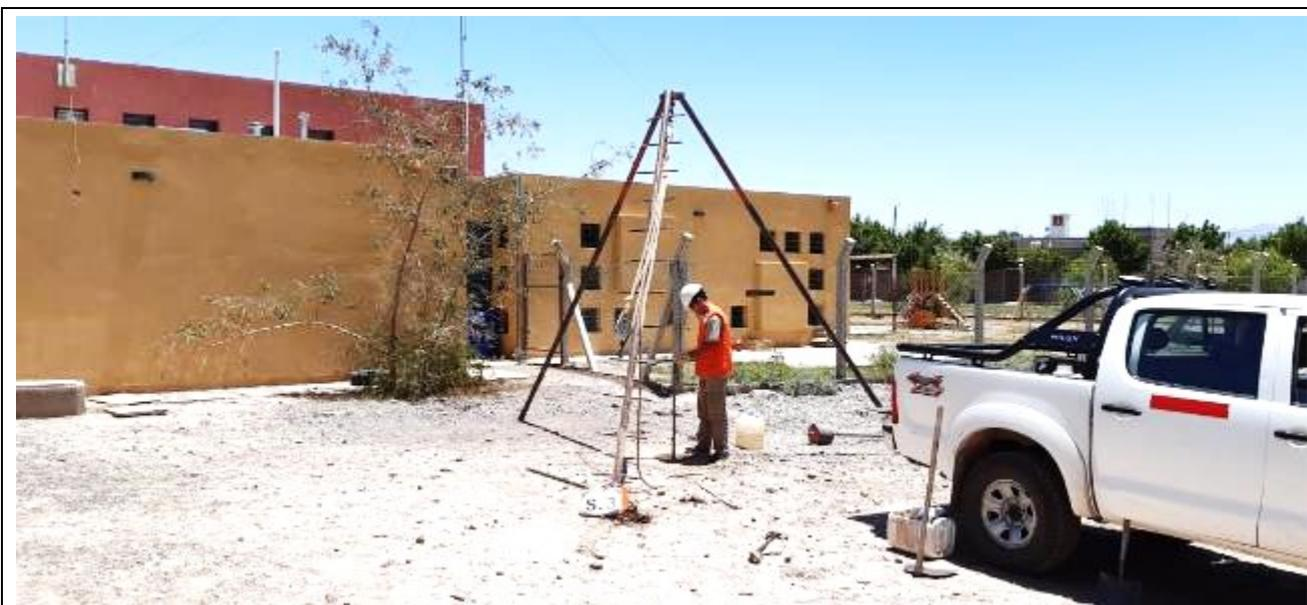
**Fotografía N°12:** Vista de la posición en el terreno del Sondeo **S.3**. Se observan los trabajos de perforación y toma de muestra, como así también el ensayo de penetración estándar (SPT).
