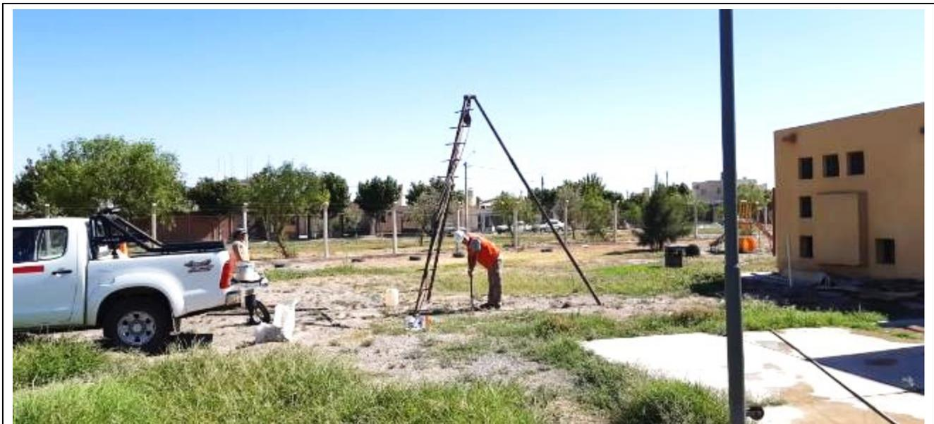
**Fotografía N°4:** Vista de la posición en el terreno del Sondeo S.1. Se observan los trabajos de perforación y toma de muestra, como así también el ensayo de penetración estándar (SPT).
