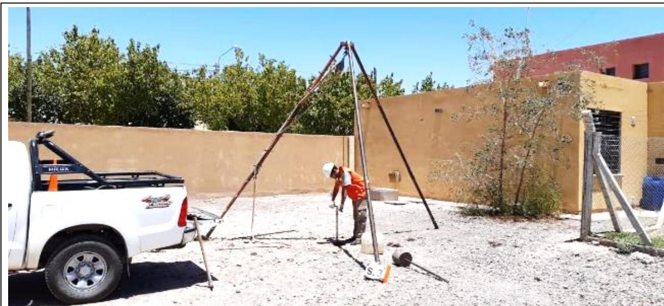
**Fotografía N°11:** Vista de la posición en el terreno del Sondeo **S.3**. Se observan los trabajos de perforación y toma de muestra, como así también el ensayo de penetración estándar (SPT).
