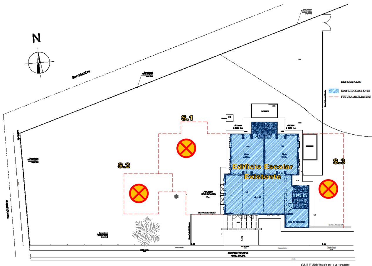
Figura N° 2: Se muestra la posición de los sondeos ejecutados en el terreno estudiado.
