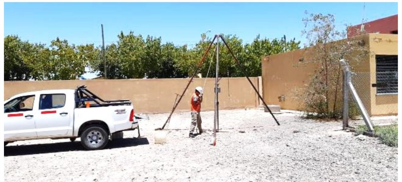
**Fotografía N°13:** Vista de la posición en el terreno del Sondeo **S.3**. Se observan los trabajos de perforación y toma de muestra, como así también el ensayo de penetración estándar (SPT).
