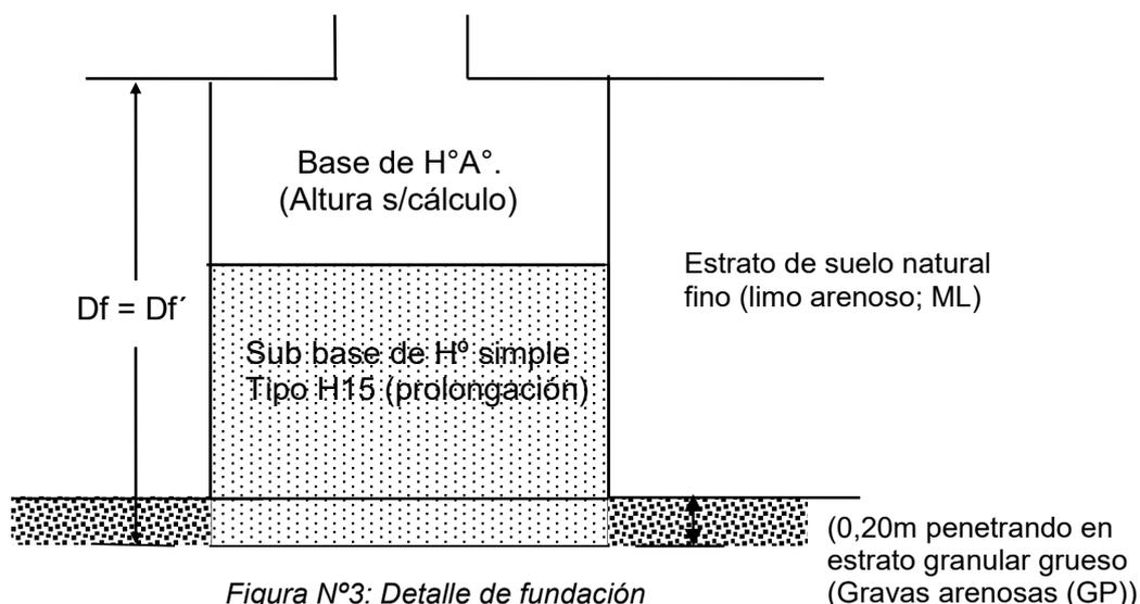
Figura N°3: Detalle de fundación
