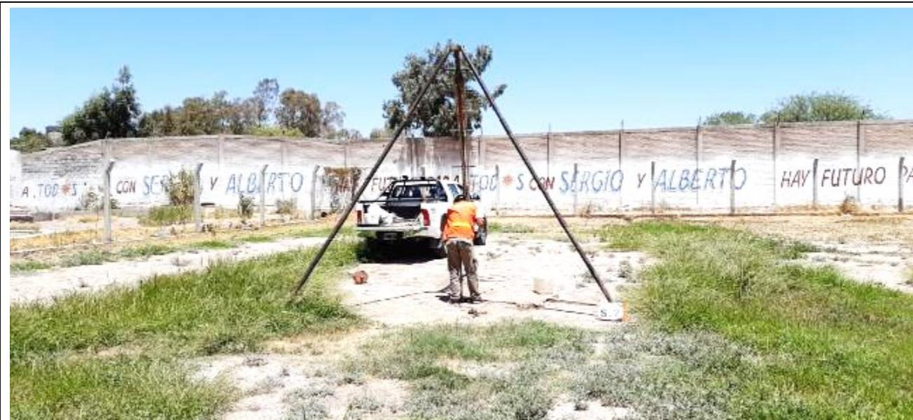
**Fotografía N°9:** Vista de la posición en el terreno del Sondeo **S.2**. Se observan los trabajos de perforación y toma de muestra, como así también el ensayo de penetración estándar (SPT).
