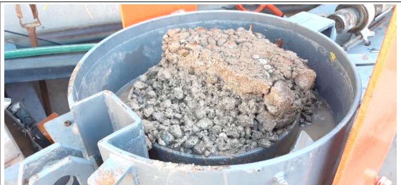
Fotografía N°16: Se muestra la probeta ensayada a corte rápido para la calicata C.2 – Prof.= 1,40m; observando el plano de corte.
