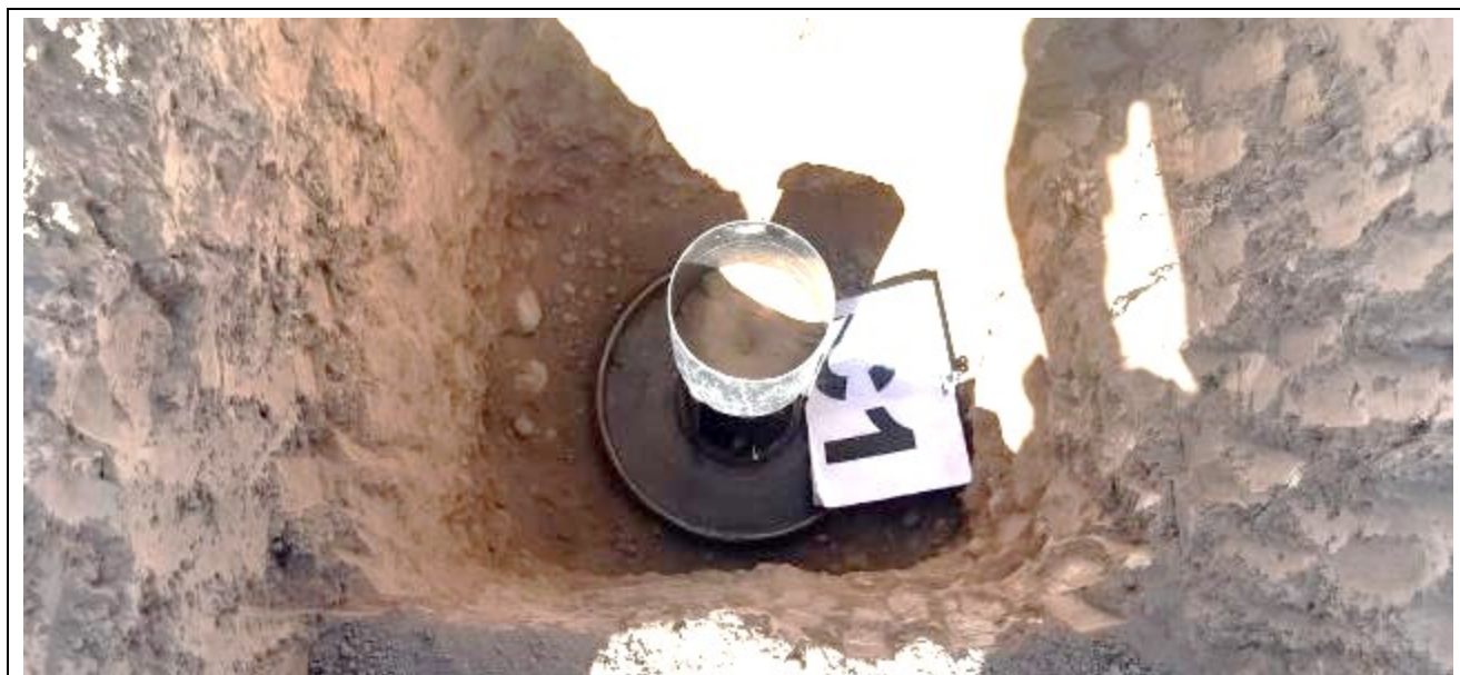
Fotografía N°4: Calicata C.1. Se muestra el perfil estratigráfico de suelos formado por un estrato superior de limo arenoso de 0,90m de espesor, y subyacente aparece el estrato granular grueso del cono aluvial del Río San Juan formado por una grava arenosa. Se muestra el ensayo de densidad in situ por el método del cono y la arena (Norma DNV) a la profundidad de 1,30m en el estrato granular grueso formado por una grava arenosa
