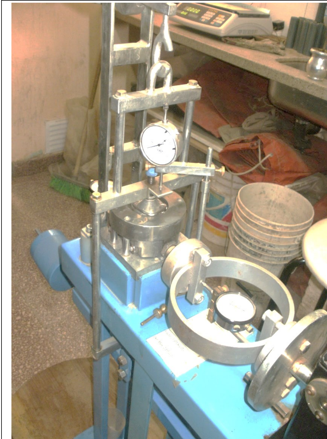
Fotografía N° 17: Muestra de la calicata C.1 - Prof.= 0,50m, correspondiente a limo arenoso remoldeada. Probeta ensayada. Laboratorio de ING SRL. Suelo fino bajo # 10. Celda de Corte de 63,4 mm de diámetro
