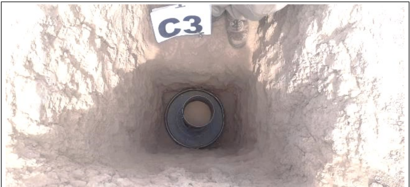
Fotografía N°13: Calicata C.3 . Se muestra el perfil estratigráfico de suelos formado por un estrato superior de limo arenoso de 1,30m de espesor, y subyacente aparece el estrato granular grueso del cono aluvial del Río San Juan formado por una grava arenosa. Se muestra el ensayo de densidad in situ por el método del cono y la arena (Norma DNV) a la profundidad de 1,60m en el estrato granular grueso formado por una grava arenosa.
