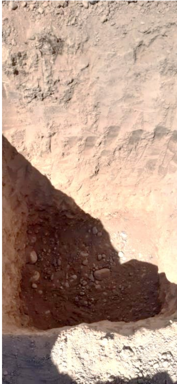
Fotografía N°5: Calicata C.1. Se muestra el perfil estratigráfico de suelos formado por un estrato superior de limo arenoso de 0,90m de espesor, y subyacente aparece el estrato granular grueso del cono aluvial del Río San Juan formado por una grava arenosa.
