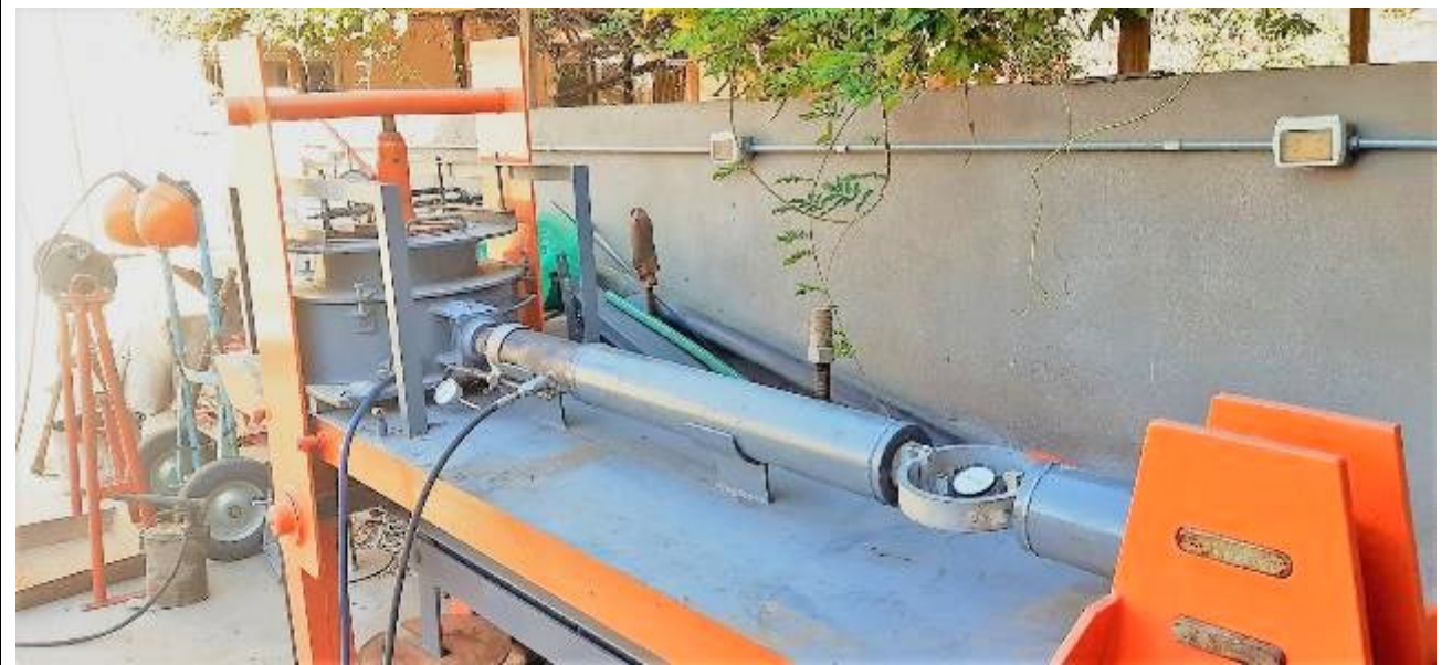
Fotografía N°15: Se observa el dispositivo de corte para suelos granulares bajo # 1 1/2" con diámetro 36cm.
