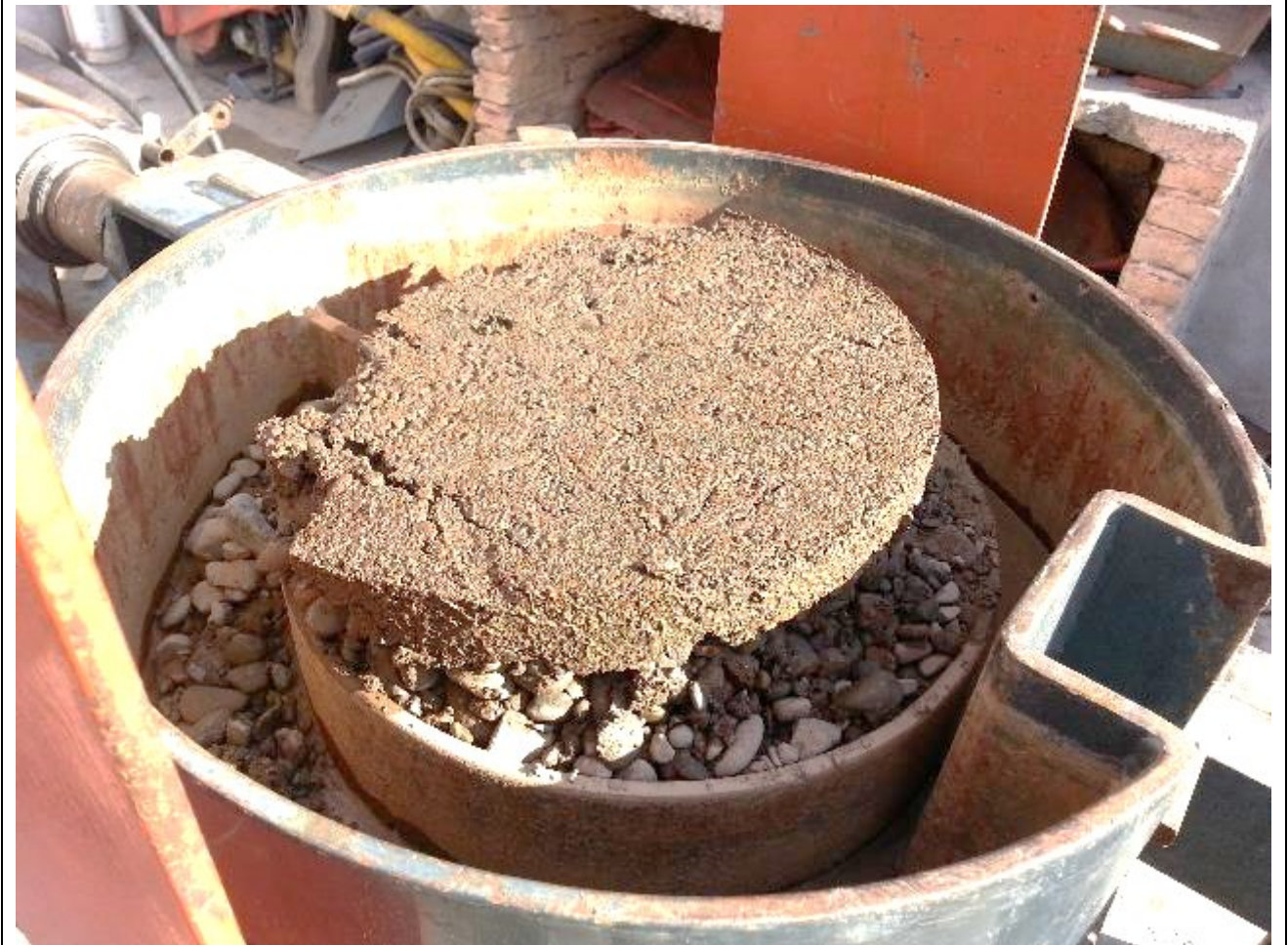
Fotografía N°13: Se muestra la probeta ensayada a corte rápido para la calicata C.2; observando el plano de corte.
