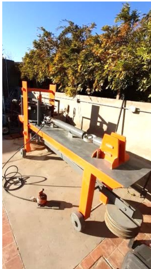
Fotografía N°11 y 12: Se observa el dispositivo de corte para suelos granulares bajo #1 1/2" con diámetro 36cm.
