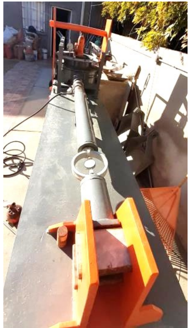
Fotografía N°11 y 12: Se observa el dispositivo de corte para suelos granulares bajo #1 1/2" con diámetro 36cm.
