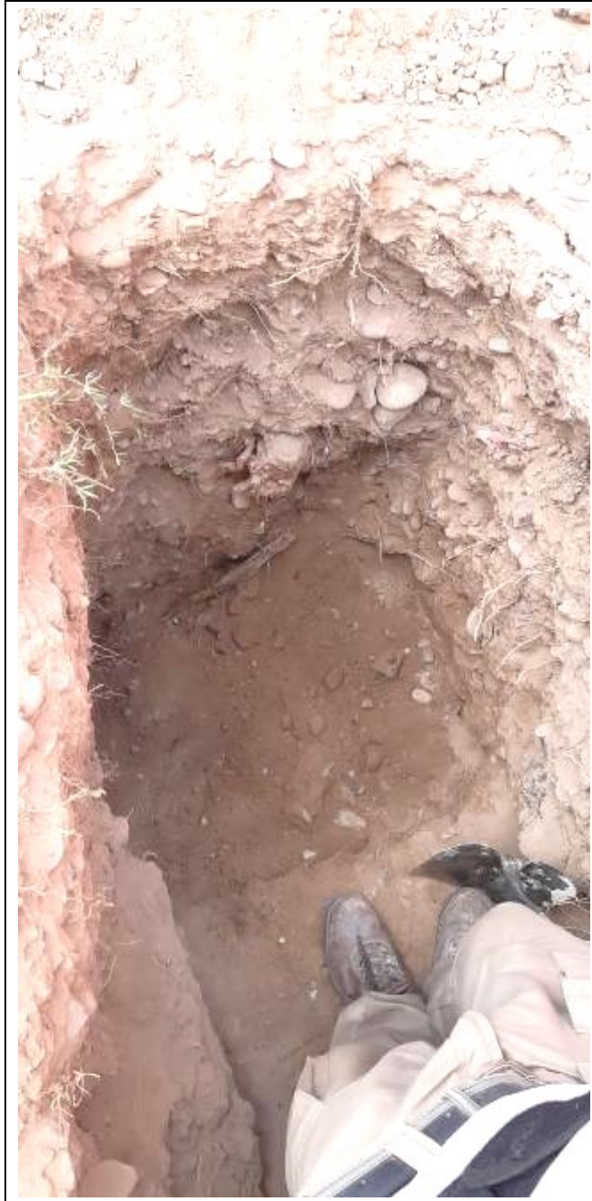
Fotografía N°10: Calicata C.3 . Se muestra el perfil estratigráfico de suelos formado por un relleno superior de limo arenoso con gravas.
