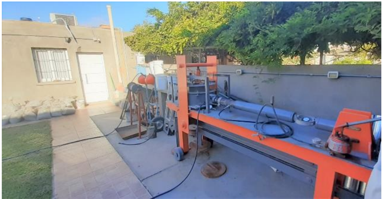
Fotografía N°16: Se observa el dispositivo de corte para suelos granulares bajo # 1 1/2" con diámetro 36cm.
