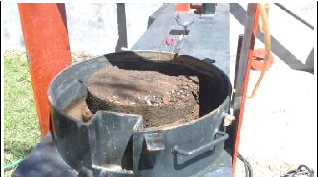
Fotografía N°17: Se muestra la probeta ensayada a corte rápido para la calicata C.2; observando el plano de corte.
