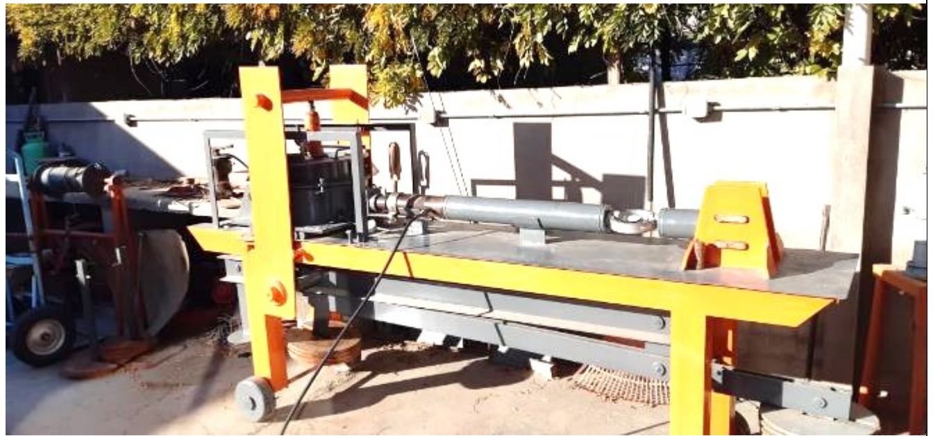
Fotografía N°8: Se observa el dispositivo de corte armado para suelos granulares, con caja de corte de diámetro 36cm.
