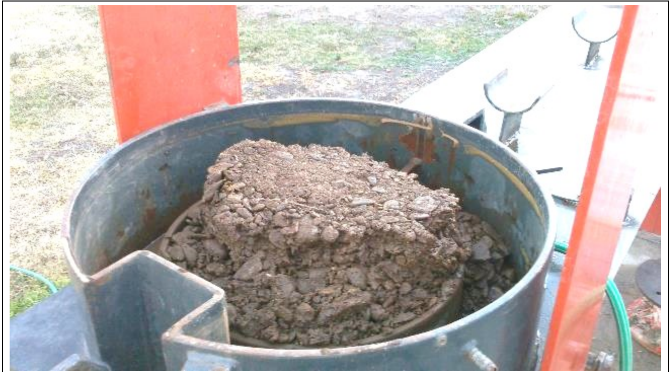
Fotografía N°10: Se observa el dispositivo de corte armado para suelos granulares y la muestra ensayada, con caja de corte de diámetro 36cm.
