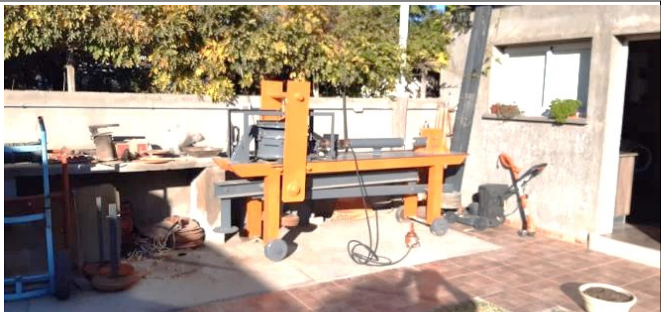
Fotografía N°9: Se observa el dispositivo de corte armado para suelos granulares, con caja de corte de diámetro 36cm.
