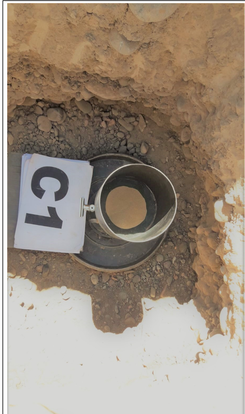
Fotografía N°4: Calicata C.1. Se muestra el perfil estratigráfico de suelos formado por un relleno superior de 0,30m, le continúa el primer estrato de suelo natural formado por un limo arenoso con gravas de 0,10m de espesor y a la profundidad de 0,40m aparece subyacente el estrato granular grueso del cono aluvial del Río San Juan formado por una grava arenosa. Se muestra el ensayo de densidad in situ por el método del cono y la arena (Norma DNV) a la profundidad de 1,00m en el estrato granular grueso formado por una grava arenosa.
