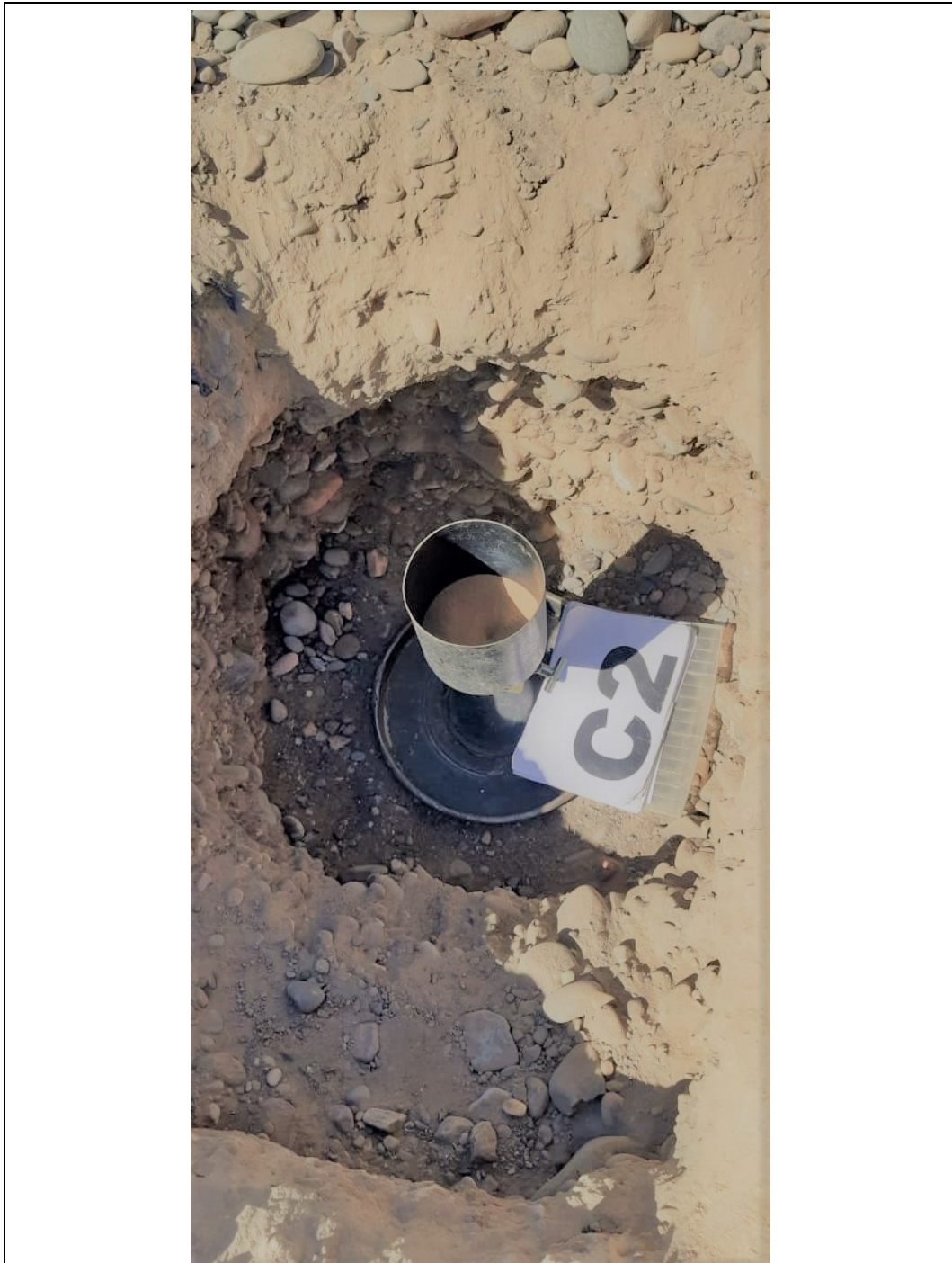
Fotografía N°7: Calicata C.2. Se muestra el perfil estratigráfico de suelos formado por un relleno superior de 0,20m, le continúa el primer estrato de suelo natural formado por un limo arenoso con gravas de 0,10m de espesor y a la profundidad de 0,30m aparece subyacente el estrato granular grueso del cono aluvial del Río San Juan formado por una grava arenosa. Se muestra el ensayo de densidad in situ por el método del cono y la arena (Norma DNV) a la profundidad de 1,00m en el estrato granular grueso formado por una grava arenosa.
