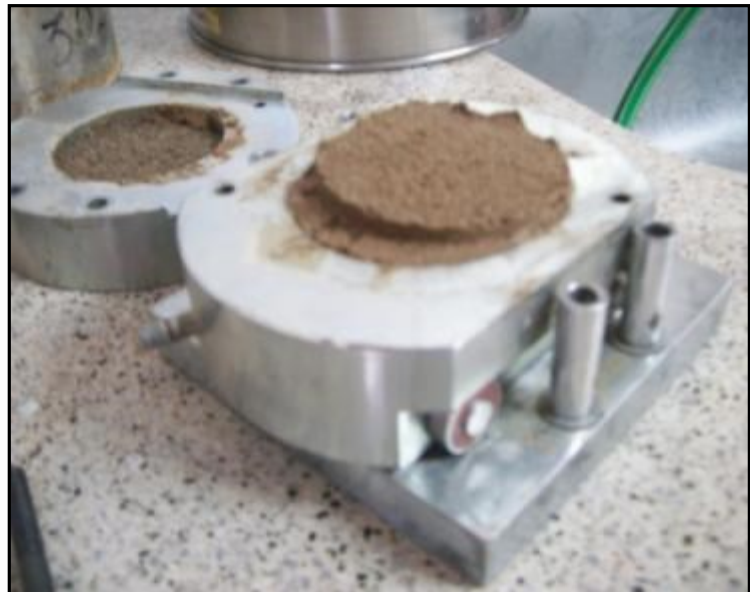
Fotografía N°4: Probeta ensayada, vista del plano de corte
