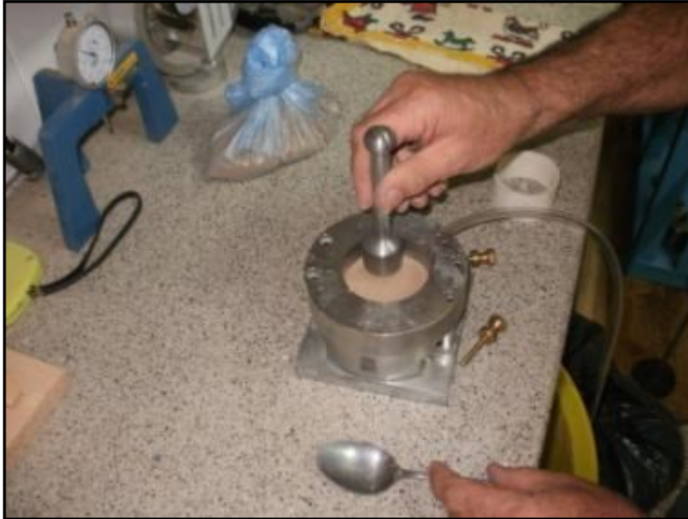
Fotografía N°3: Moldeo de Probeta de corte.
