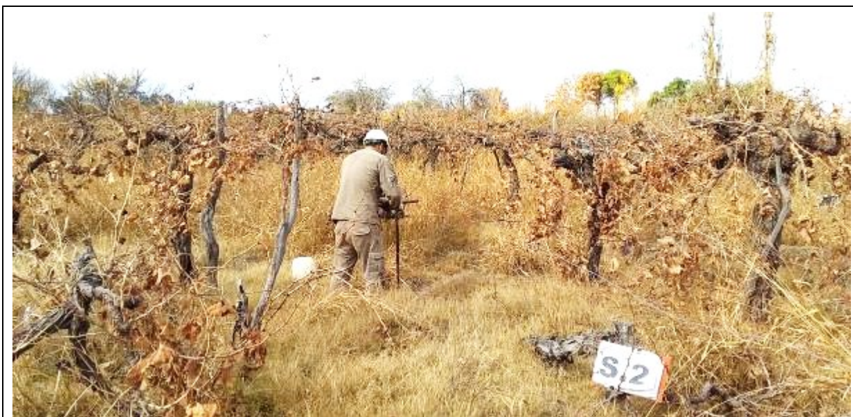
Fotografía N°11: Vista de la posición en el terreno del Sondeo S.2 . Se observan los trabajos de perforación y toma de muestra.
