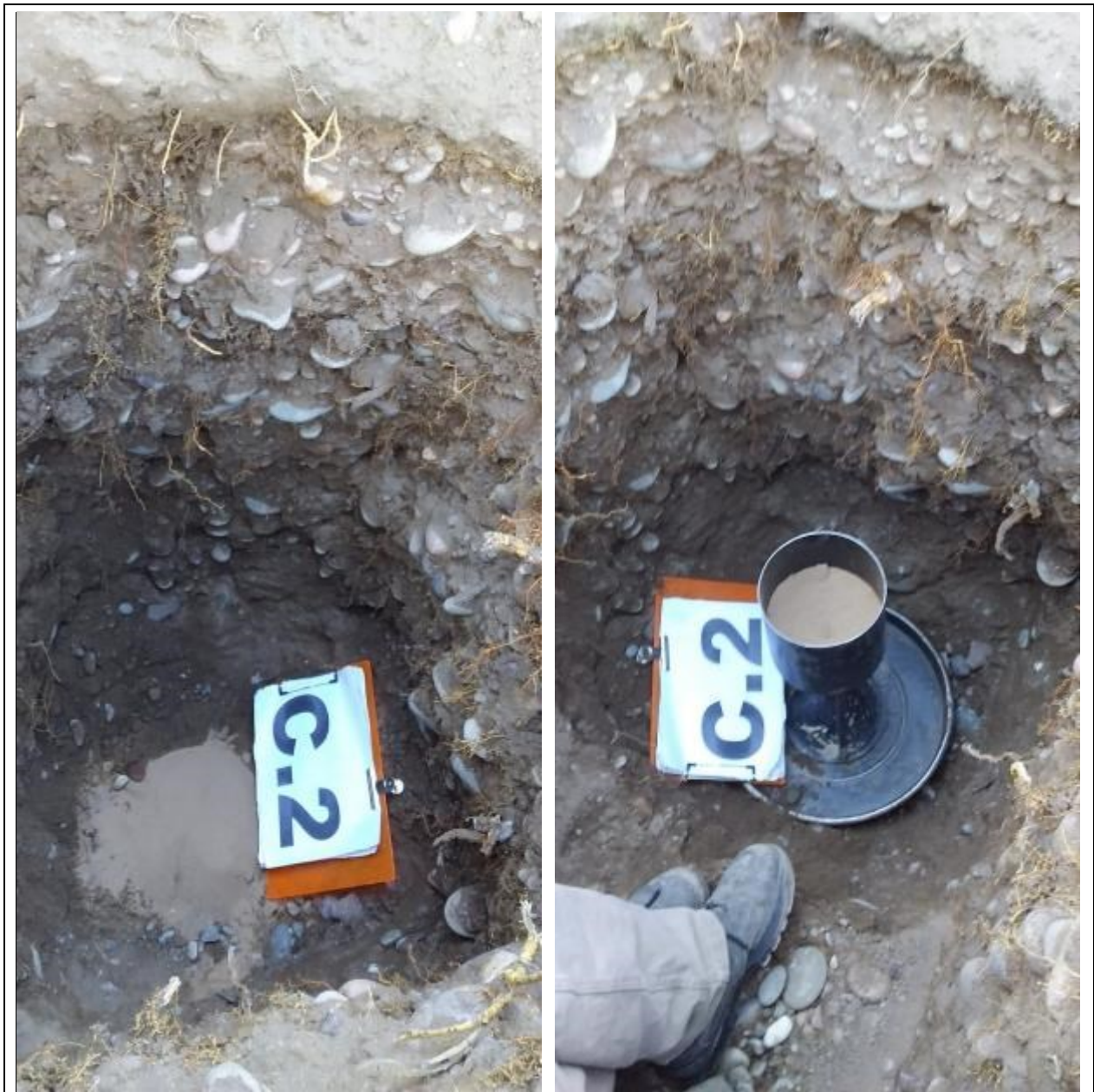
Fotografía N°17 y 18: Se muestra la excavación de la calicata C.2 , observando el perfil estratigráfico de suelos compuesto por un suelo natural granular grueso formado por gravas arenosas. Se observa el ensayo de densidad in situ a la Prof. de 1,10m en el estrato de gravas arenosas.
