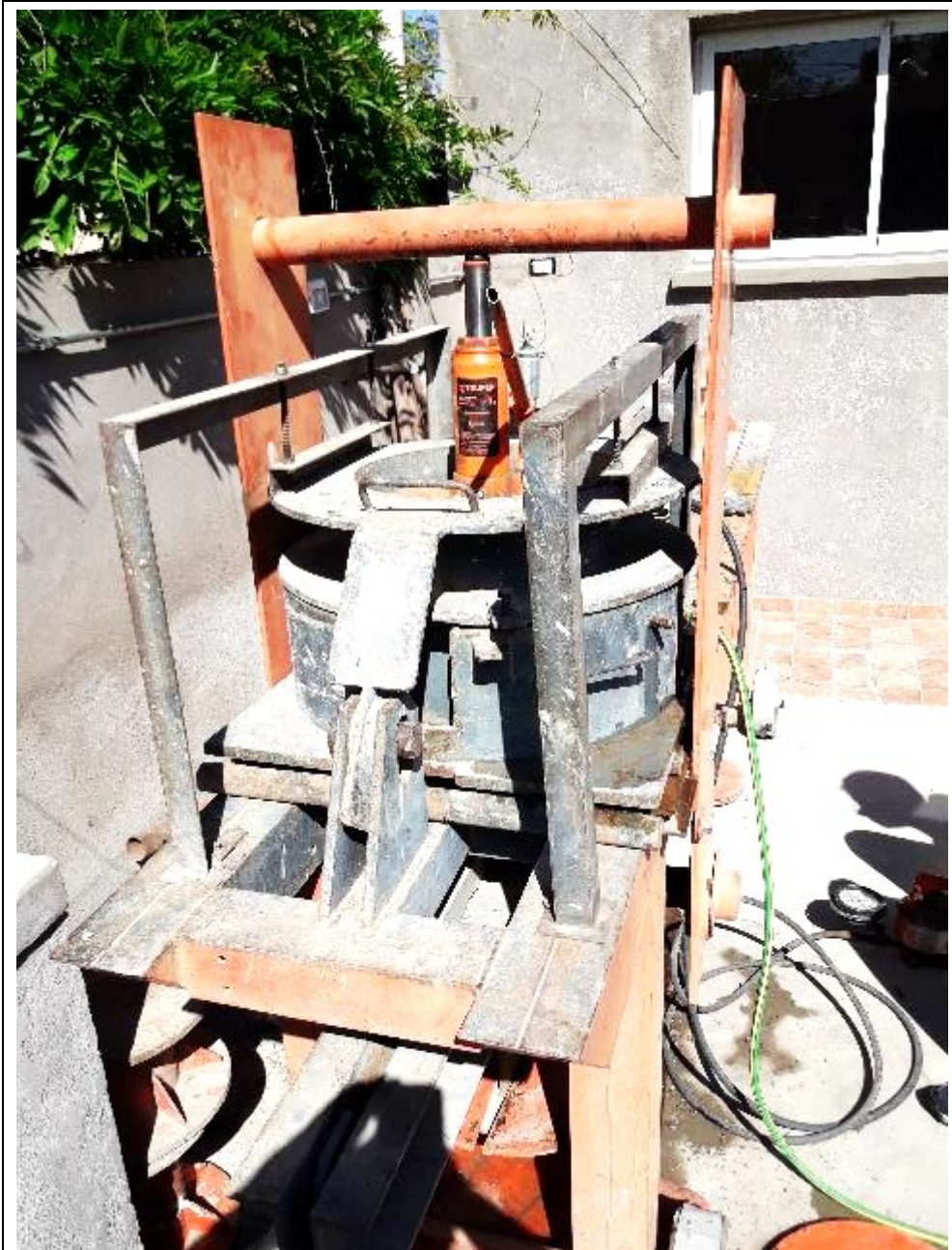
Fotografía N°19: Se observa el dispositivo de corte armado para suelos granulares, con caja de corte de diámetro 36cm.
