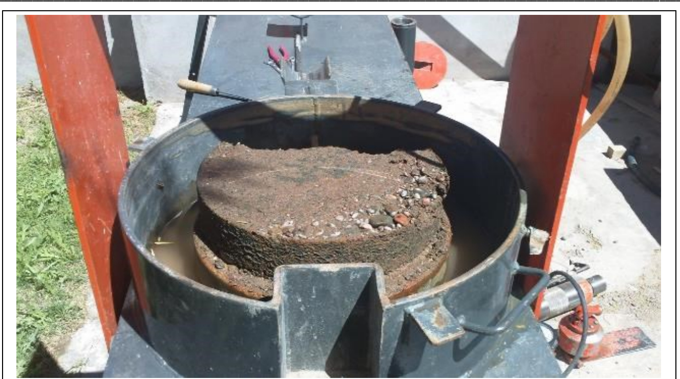
Fotografía N°20: Se muestra la probeta ensayada a corte rápido observando el plano de corte.
