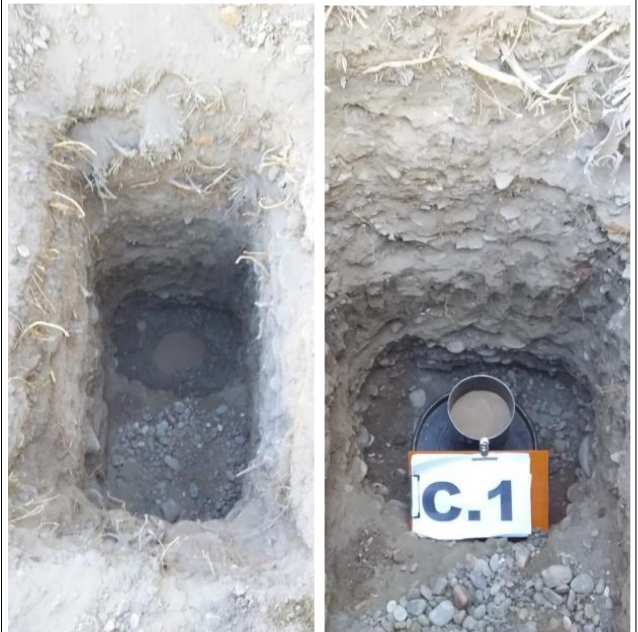
Fotografía N°11 y 12: Se muestra la excavación de la calicata C.1 , observando el perfil estratigráfico de suelos compuesto formado por un relleno superior de 1,30m, le continúa el estrato de suelo natural granular grueso formado por gravas arenosas. Se observa el ensayo de densidad in situ a la Prof. de 1,80m en el estrato subyacente de gravas arenosas.
