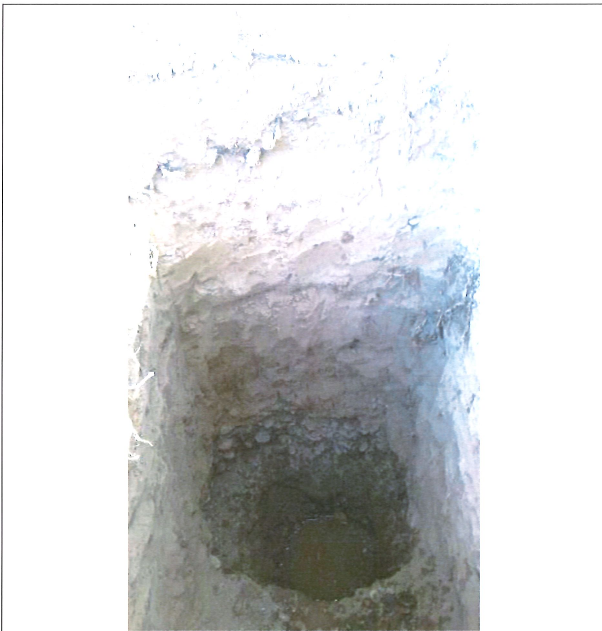
Fotografía N°7: Se muestra la excavación de la calicata C.1 , observando el perfil estratigráfico de suelos compuesto formado por un relleno superior de 0,70m, le continúa el primer estrato de suelo natural de limo arenoso y subyacente a la profundidad de 1,40m el comienzo del segundo estrato granular grueso formado por gravas limpias.
