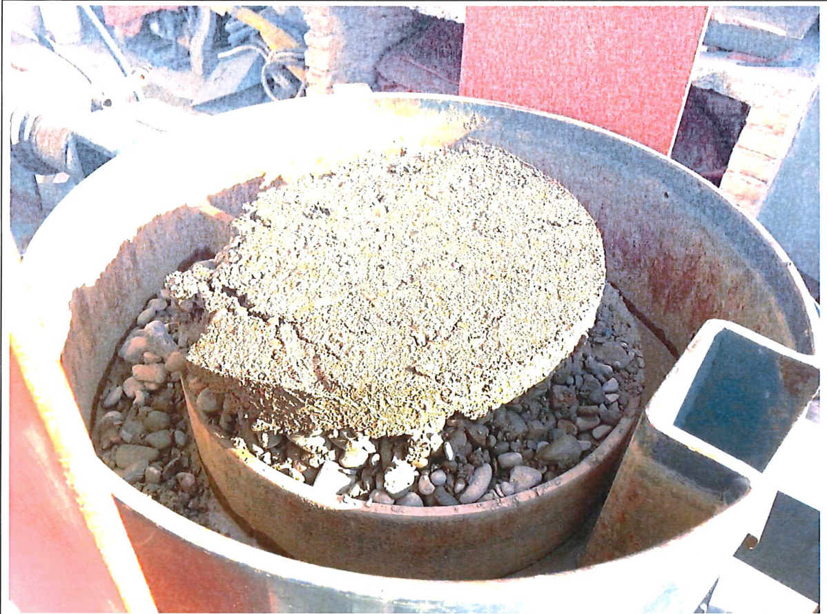
Fotografía N°23: Se muestra la probeta ensayada a corte rápido observando el plano de corte.
