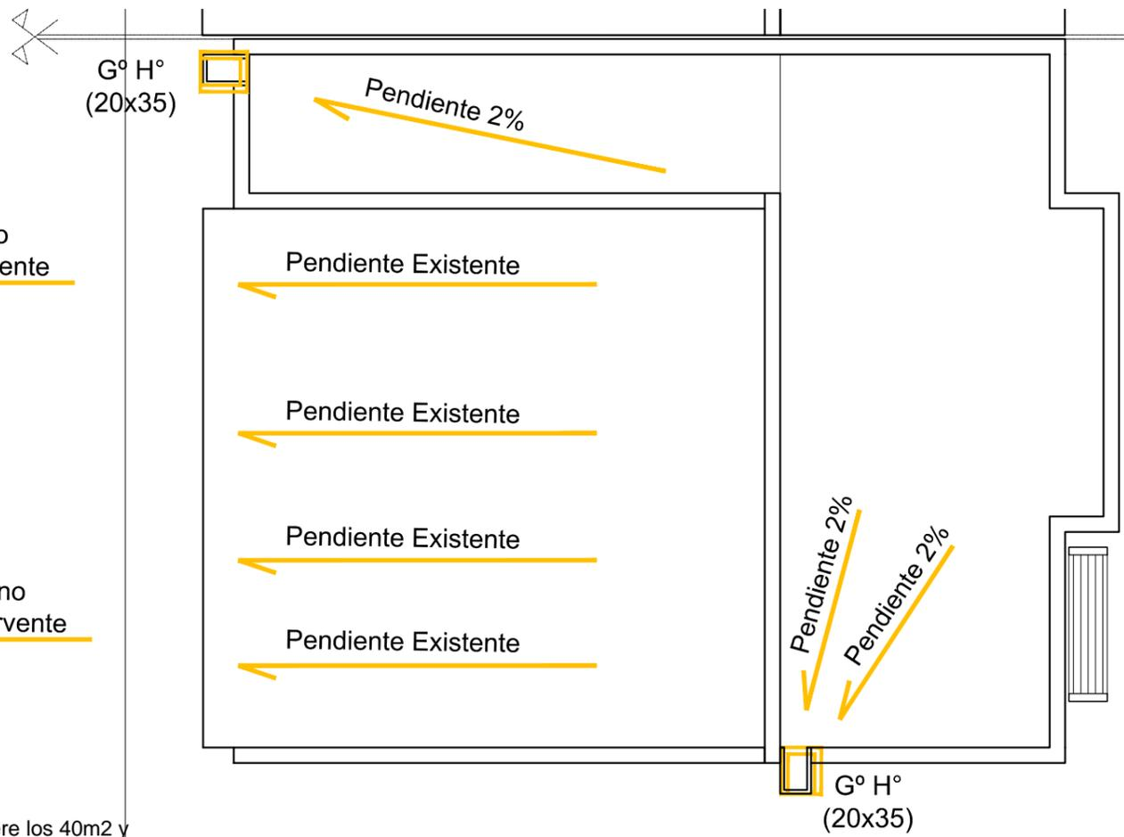
**Nota:** Cuando no exista terreno absorbente, se deberá colocar rejillas de desagüe pluvial, con su cálculo correspondiente.
