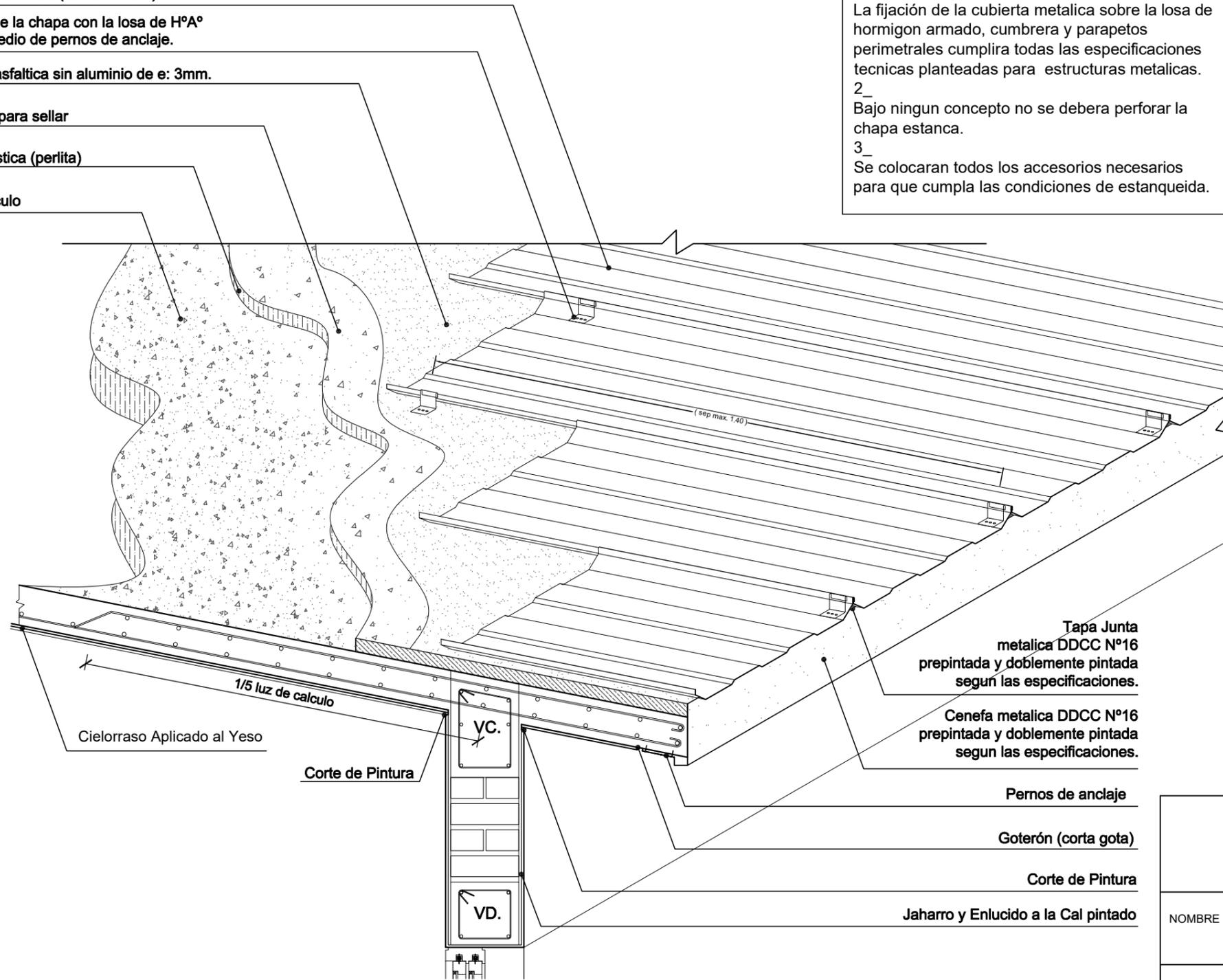
Tapa Junta metálica DDCC N°16 prepintada y doblemente pintada según las especificaciones.
