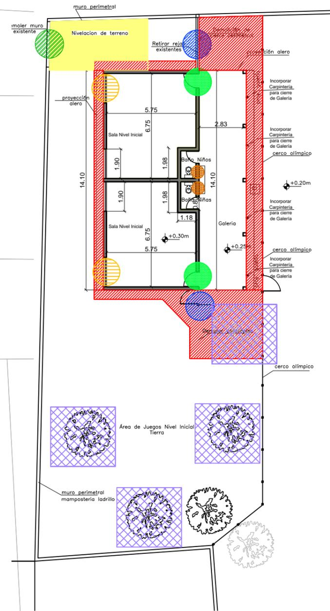
PLANTA DE DEMOLICIÓN Esc: 1:100
