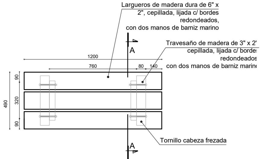
**DETALLE FIJACION DE ASIENTO DE MADERA CON PATA DE HºAº**
