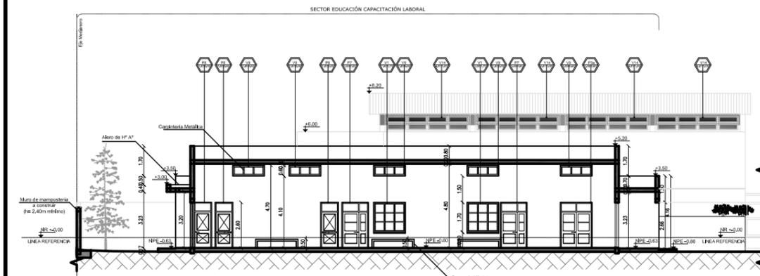
CORTE 9 - 9 (CORTE LONGITUDINAL. Edificio de Capacitación Laboral).
