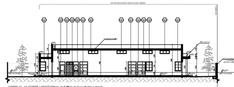
CORTE 13 - 13 (CORTE LONGITUDINAL de Edificio de Capacitación Laboral).
