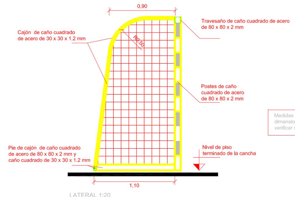
Medidas y secciones de la estructura, y dimensiones de bases estimativas a verificar según cálculo por la contratista.
