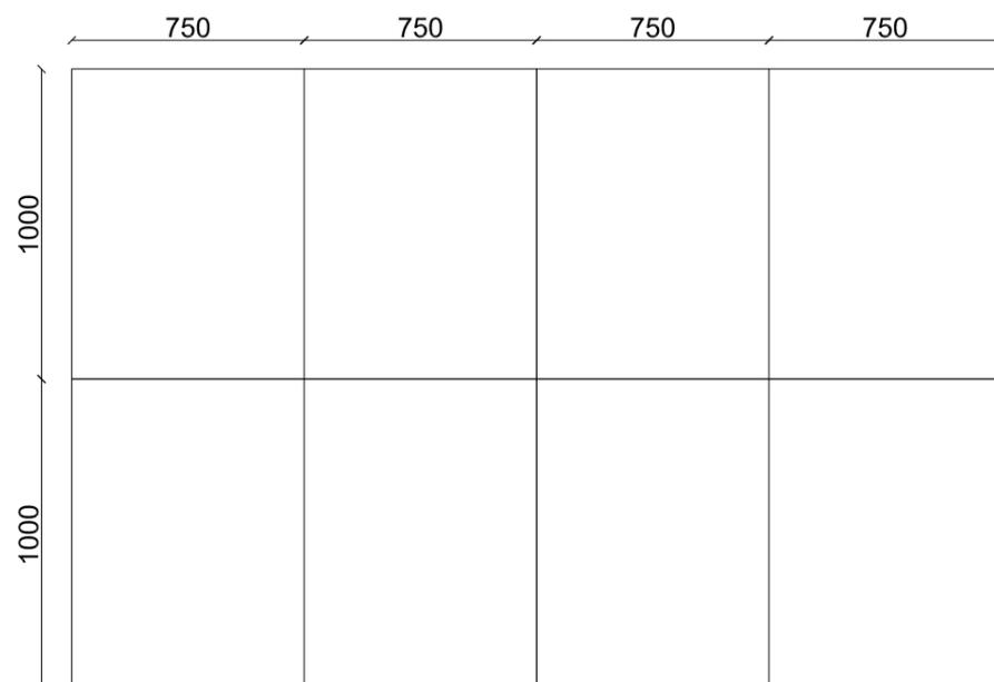
8 módulos de 1000 x 750 mm. de chapa negra nº 26 o 24 con soporte o estructura de madera.
