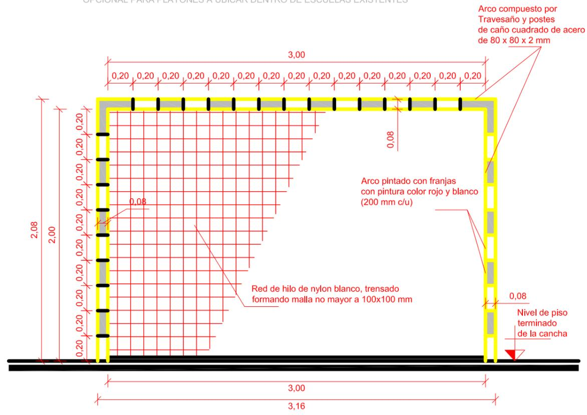
Eztarán amurados al piso a través de tornillos autoajustables, para evitar el vuelco mientras se esté usando.
