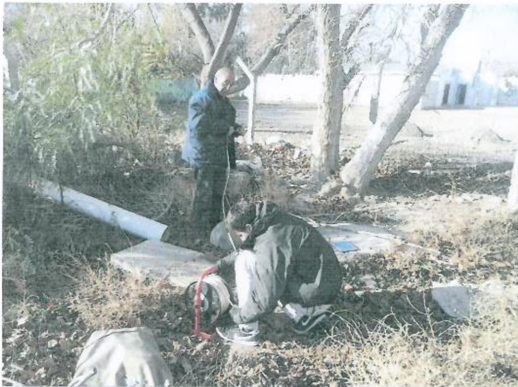
*Fotografía N°1: Personal del INA-CRAS durante la tarea de medición del nivel piezométrico.*
