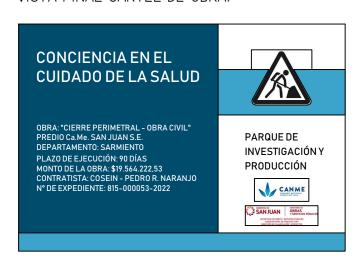
LA DISTANCIA DE COLOCACIÓN DEL CARTEL RESPECTO AL BORDE DEL SUELO SERÁ DE 2.00M (TENER EN CUANTA AL PLANTEAR LA ESTRUCTURA DE SOPORTE).
