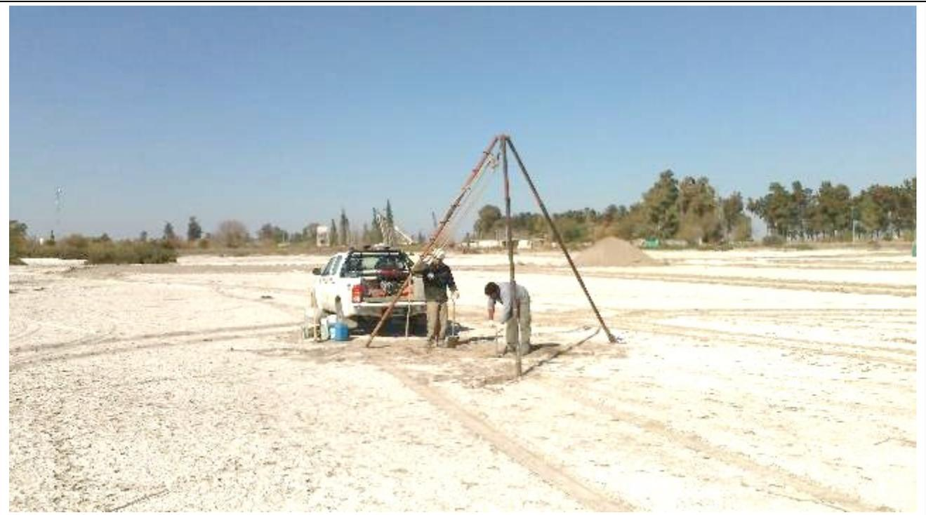
**Fotografía N°5:** Vista de la posición en el terreno del Sondeo **S.2**. Se observan los trabajos de perforación y toma de muestra, como así también el ensayo de penetración estándar (SPT).
