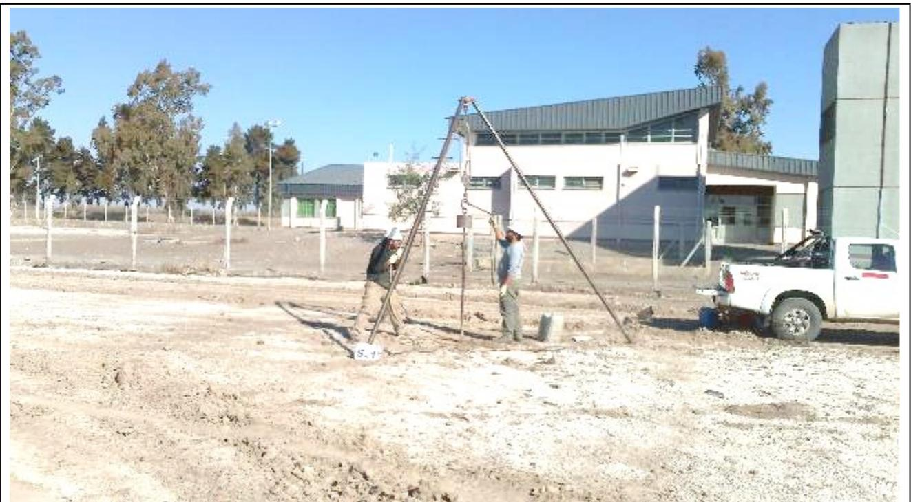
**Fotografía N°4:** Vista de la posición en el terreno del Sondeo **S.1**. Se observan los trabajos de perforación y toma de muestra, como así también el ensayo de penetración estándar (SPT).
