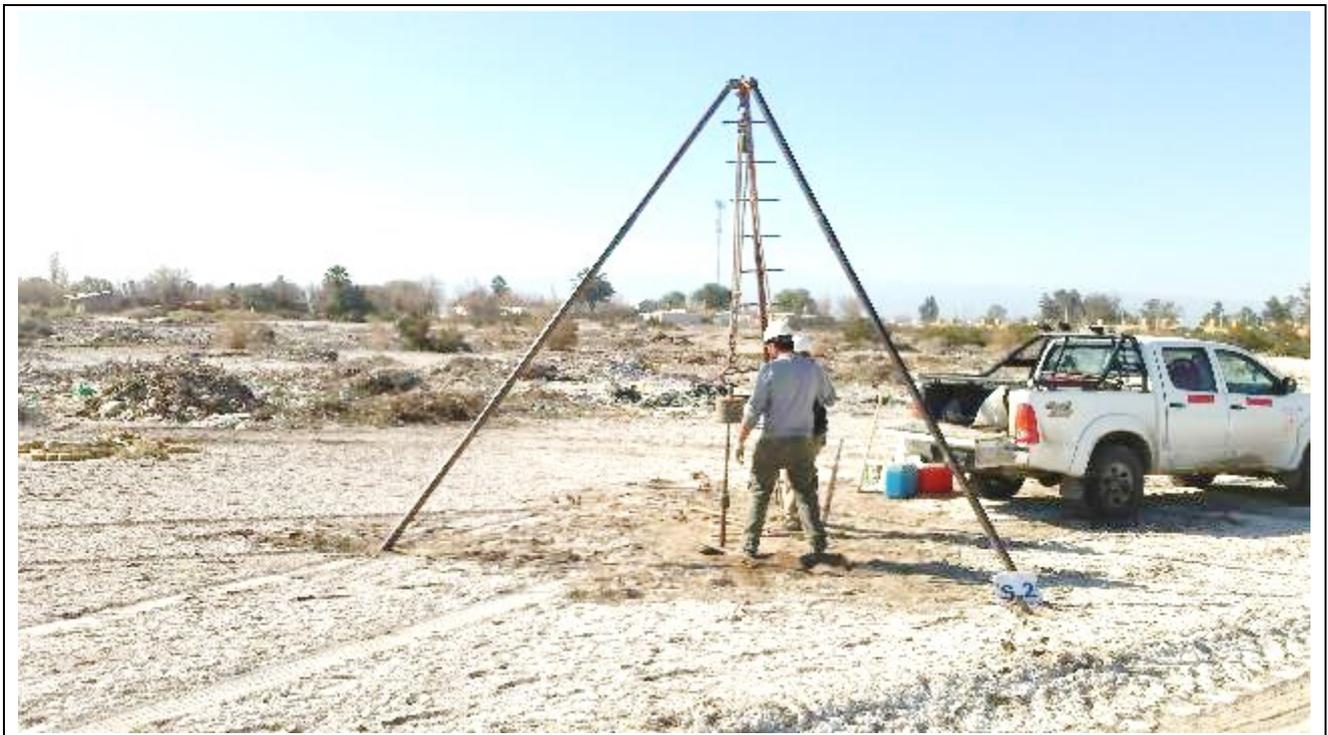
**Fotografía N°9: S.1.** Vista de la posición en el terreno del Sondeo S.2. Se observan los trabajos de perforación y toma de muestra, como así también el ensayo de penetración estándar (SPT).
