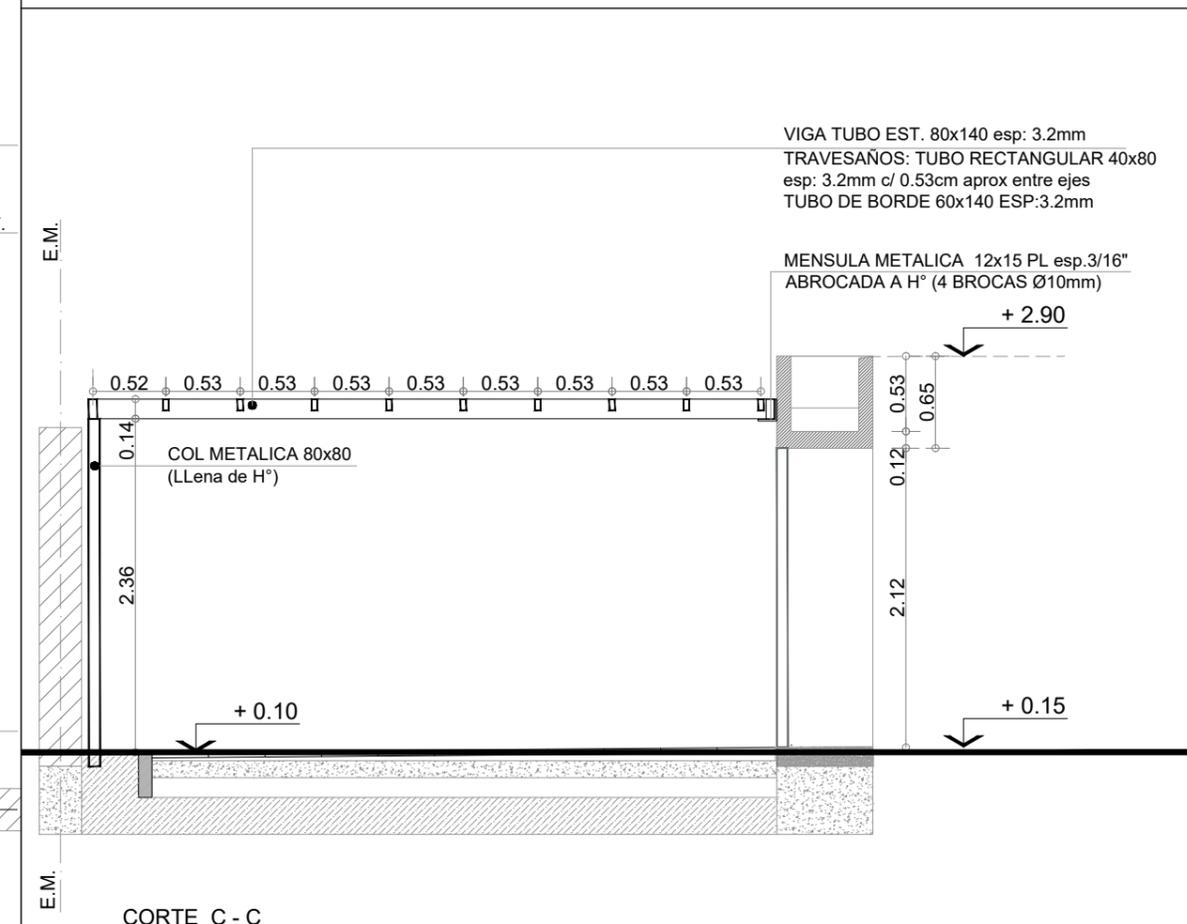
VIGA TUBO EST. 80x140 esp: 3.2mm
