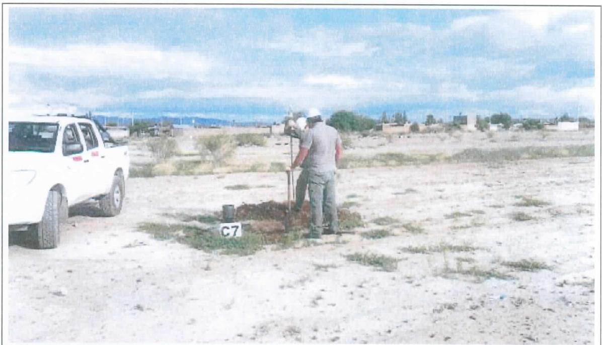
**Foto N°12:** Se muestra la posición de la calicata C.7 en el terreno estudiado y los trabajos de excavación y toma de muestra.
