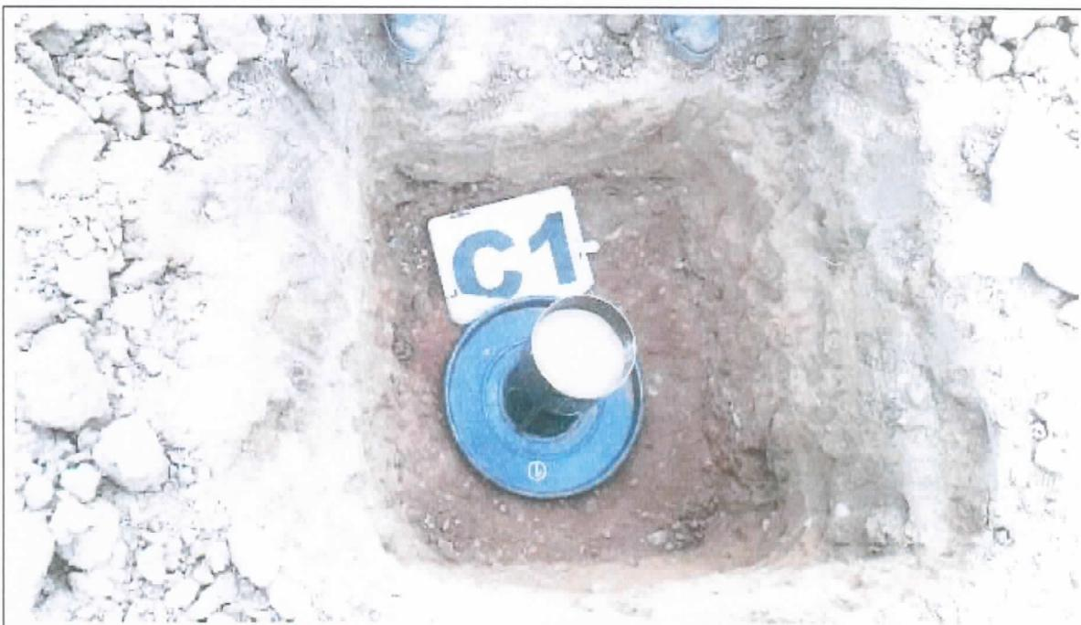
**Foto N°5:** Se muestra la excavación de la calicata C.1, observando el perfil estratigráfico de suelos compuesto por un estrato superior de limo arenosos con algunas gravas, y subyacente el estrato granular grueso formado por gravas limpias. Se observa el ensayo de densidad in situ a la profundidad de 1,20m.
