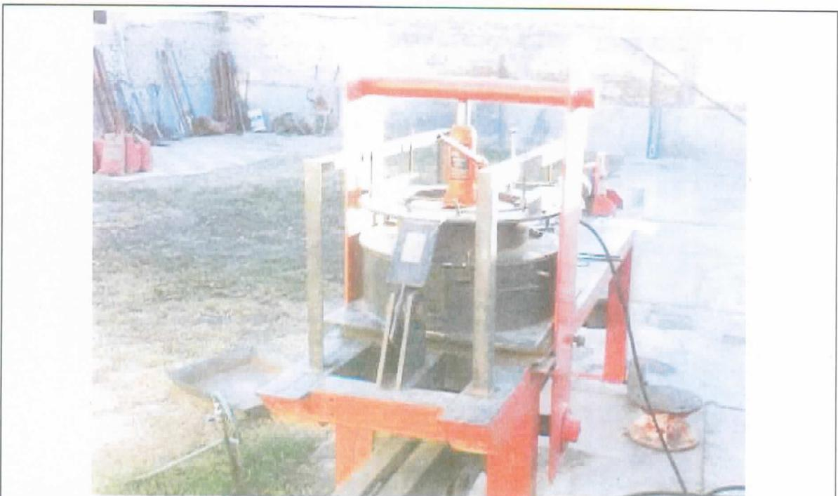
**Foto N° 16:** Se observa el dispositivo de corte para suelos granulares bajo #1 1/2" con diámetro 36cm.
