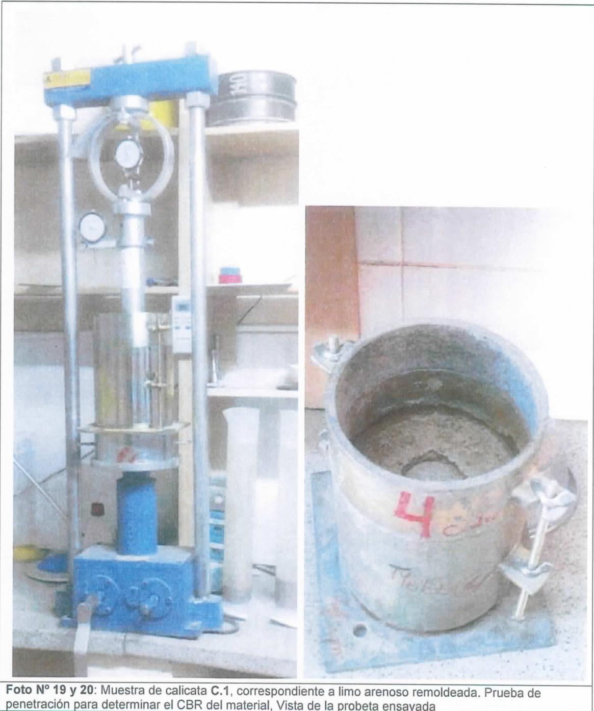
**Foto N° 19 y 20:** Muestra de calicata C.1, correspondiente a limo arenoso remoldeada. Prueba de penetración para determinar el CBR del material, Vista de la probeta ensayada
