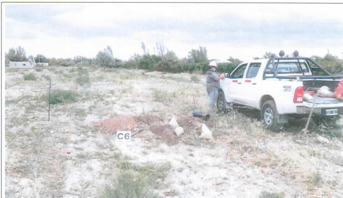
**Foto N°10:** Se muestra la posición de la calicata C.6 en el terreno estudiado y los trabajos de excavación y toma de muestra.
