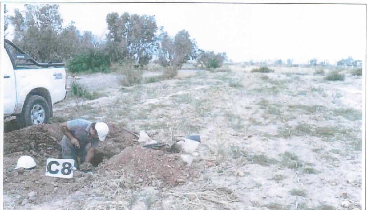
**Foto N°14:** Se muestra la posición de la calicata C.8 en el terreno estudiado y los trabajos de excavación y toma de muestra.
