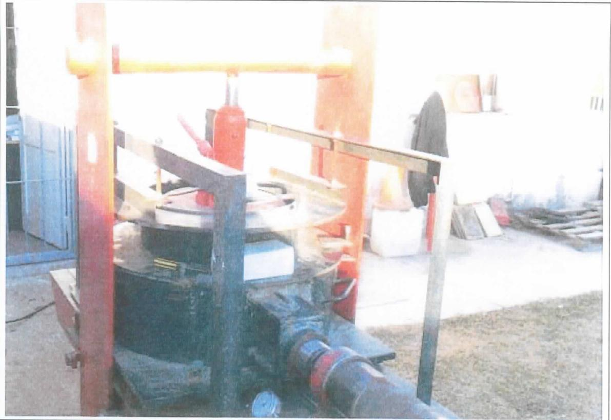
Foto N° 17: Se observa el dispositivo de corte para suelos granulares bajo #1 1/2" con diámetro 36cm.
