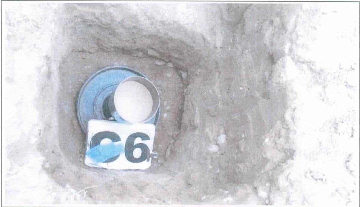
**Foto N°11:** Se muestra la excavación de la calicata C.6, observando el perfil estratigráfico de suelos compuesto por un estrato superior de limo arenosos con algunas gravas, y subyacente el estrato granular grueso formado por gravas limpias. Se observa el ensayo de densidad in situ a la profundidad de 1,20m.
