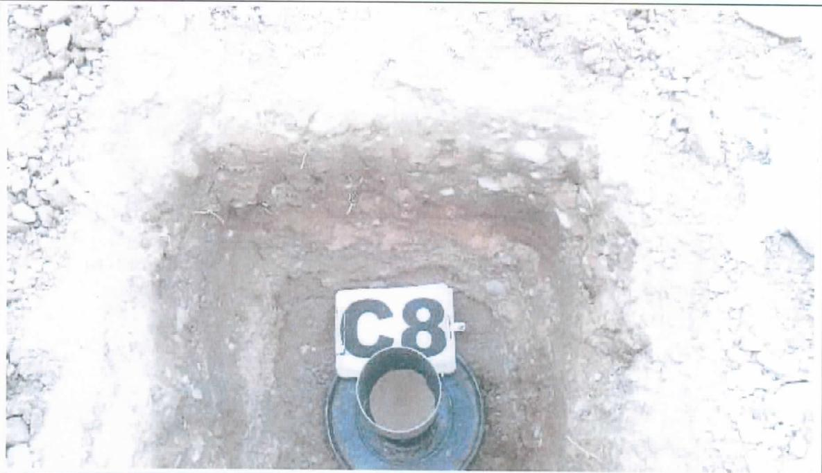
**Foto N°15:** Se muestra la excavación de la calicata C.8, observando el perfil estratigráfico de suelos compuesto por un estrato superior de limo arenosos con algunas gravas, y subyacente el estrato granular grueso formado por gravas limpias. Se observa el ensayo de densidad in situ a la profundidad de 1,10m.
