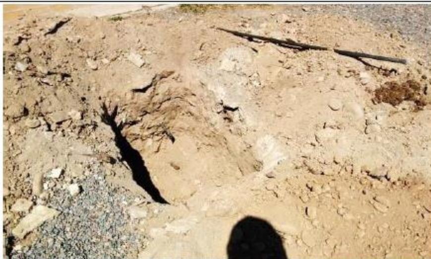
Foto N°2: Calicata C.1 Se observa el perfil estratigráfico de suelos formado por un relleno superficial de grava limosa con ladrillos y escombros de 1,20 m de espesor y subyacente el comienzo del estrato de gravas arenosas limpias.
