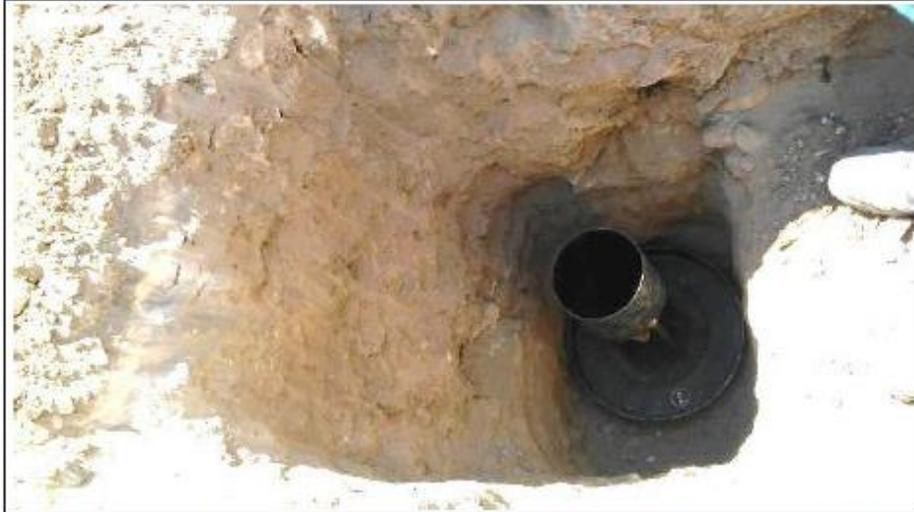
Foto N°4: Calicata C.2 Se observa el perfil estratigráfico de suelos formado por un relleno superficial de grava limosa con ladrillos y escombros de 1,20 m de espesor y subyacente el comienzo del estrato de gravas arenosas limpias.
